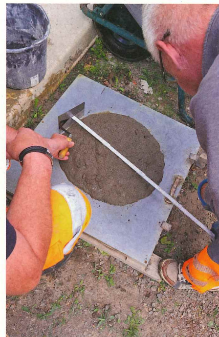
Mit dem Absetzmaß wurden Proben des Flüssigbodens auf seine Konsistenz und Fließgeschwindigkeit permanent kontrolliert – wichtig, um die vom RAL GZ 507 gesetzten Güte- und Prüfbestimmungen einzuhalten. Die Dokumentation gehörte genauso dazu. | Foto: Witing – Heinrich Lauber
